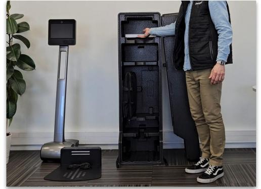
**4.** Placez le câble d'alimentation du socle de chargement sur l'une des étagères, puis inclinez le socle en l'encastrant à l'emplacement prévu à cet effet, matérialisé par des encoches et une mention "DOCK" apparaissant à droite au niveau de l'étagère centrale ;
